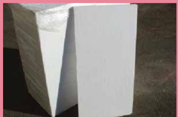
Placas de poliestireno expandido (EPS). EPS 100 (± 20 Kg/m 3 ). EPS 150 (± 25 Kg/m 3 ). Espessuras de 30 a 80 mm.
