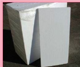
Placas de poliestireno expandido (EPS). EPS 100 ( \pm 20 \text{ Kg/m}^3 ). EPS 150 ( \pm 25 \text{ Kg/m}^3 ). Espessuras de 30 a 80 mm.
